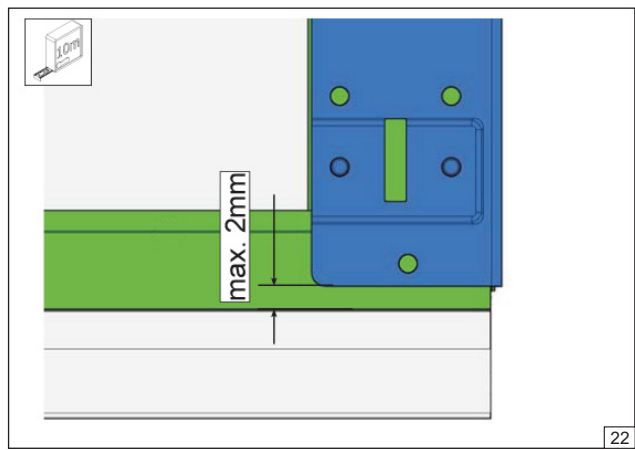
22. Avstanden fra bunn av PANELET, IKKE GUMMILISTEN til bunnen av braketten skal være maks. 2mm.
